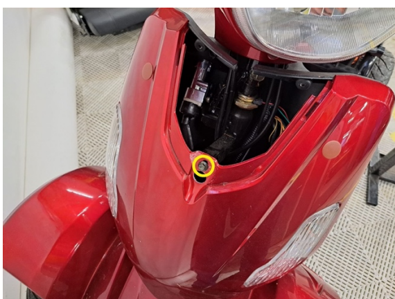
Irrota ylemmän etukatteen kiinnityspultti. (hylsy 8 mm).
