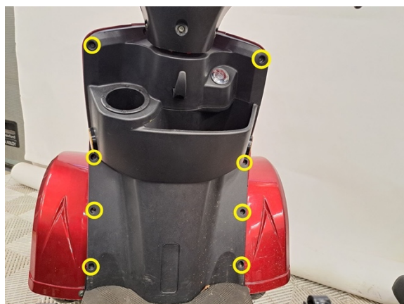
Irrota ylemmän etukatteen kiinnitysruuvit. (ristipäämeisseli ph2).
