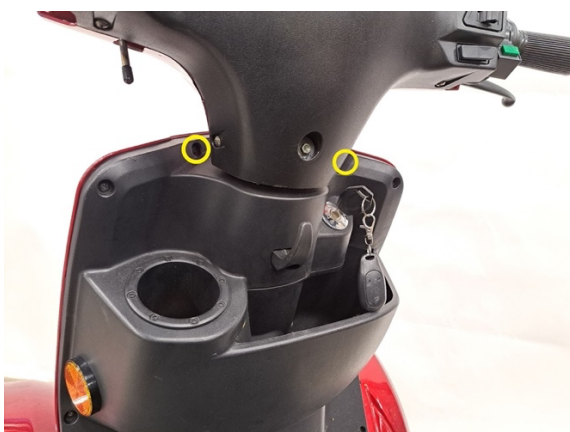
Irrota ylemmän etukatteen ylämuovin kiinnitysruuvit. (ristipäämeisseli ph2).
