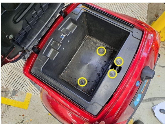
Irrota säilytyslokeron kiinnityspultit. (hylsy 8 mm).
